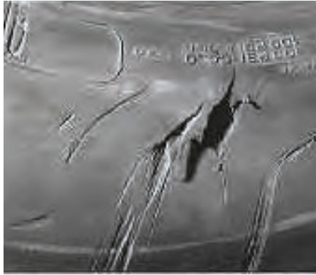
Djup penetrering av sidoväggen skada på däcket
