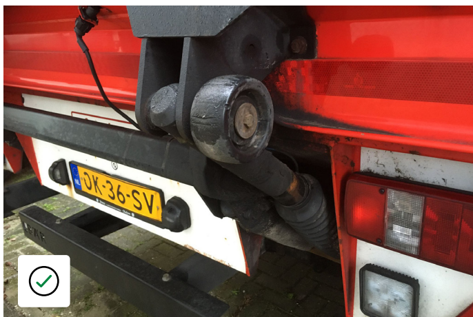
Plattformsrulle med mindre slitage
