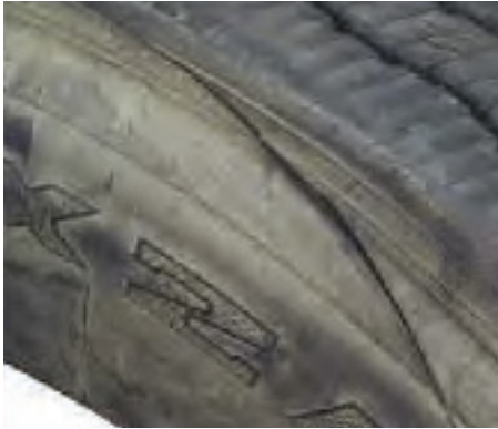
Djup penetration i däck, skuldra- och sidoväggsskador.
