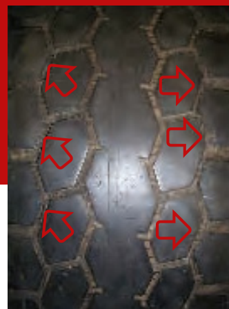
Sprickbildning i slitbanespåret på grund av för högt lufttryck
