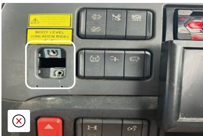
Skruvhål i instrumentbräda och klädsel saknas
