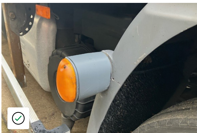
Sidoblinker och fäste i godkänt skick
