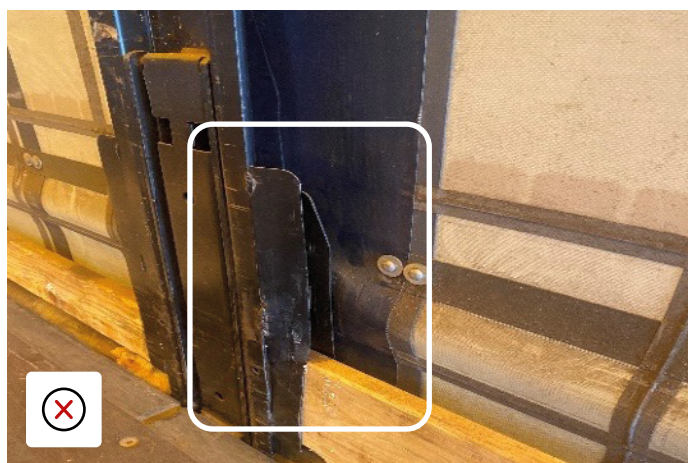
Brädhållarens fäste böjt på grund av yttreåvekan
