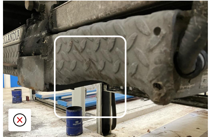
Plattformen påverkad vid en kritisk sektion - kräver reparation
