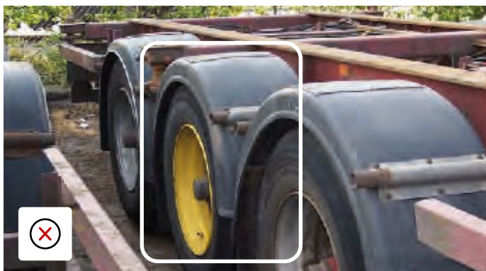
Fel färg på hjul och lappade ///wings///, skada möjligen på grund av överlast eller fel färdhöjd.
