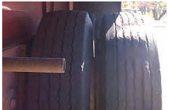
Tvillingdäck med olika diameter eller felmatchning.
