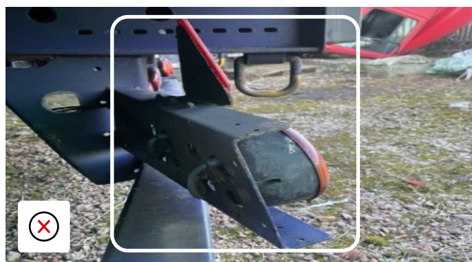
Böjd lamparm kräver reparation
