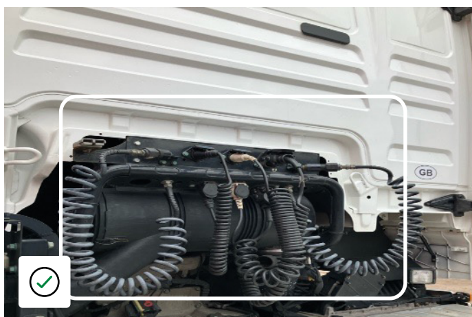
Luftbromsslangar i gott skick och korrekt förvarade
