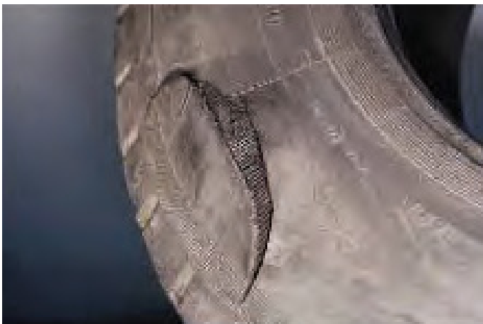
Explosion av sidovägg på grund av pentetrering
