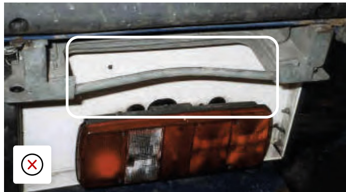
Bakre steg återlämnad skadad.
