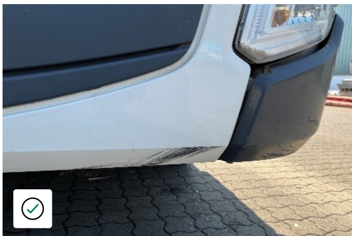
Mindre skrapskada - ingen skada på konstruktionen
