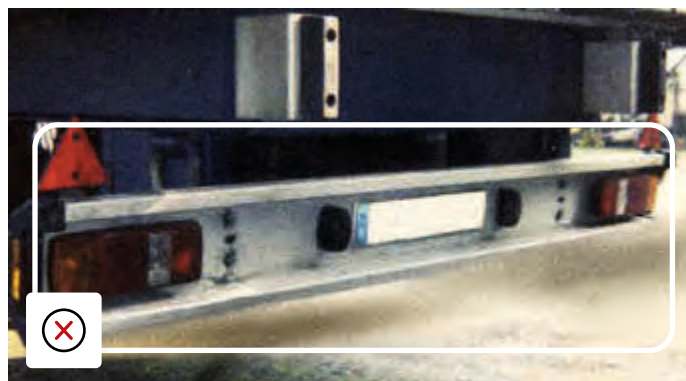
Underkörningsskyddet böjt och behöver repareras
