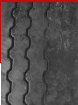
Ojämnt slitage på grund av felaktig hjulinställning
