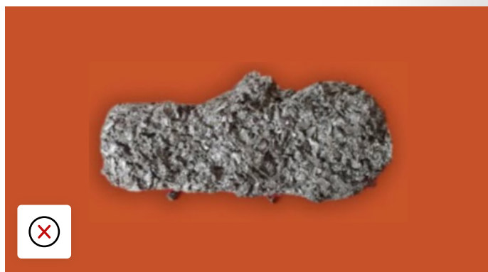
TPMS sensor i ej acceptabelt skick, kontaminerad av tättningsmedel
