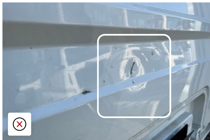
Påkörningsskada på hyttens baksida som orsakade en spricka
