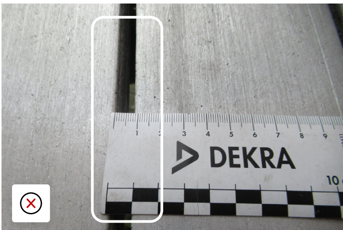
Golvprofiler är utspridda och inte säkra för transport - gods kan falla genom golvet
